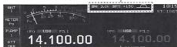
Affichage de la largeur du filtre, de la valeur de décalage et de l'état.
