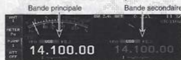
Accès à la bande principale
